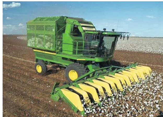
Figure 2.2: Récolteuse mécanique de type stripper
