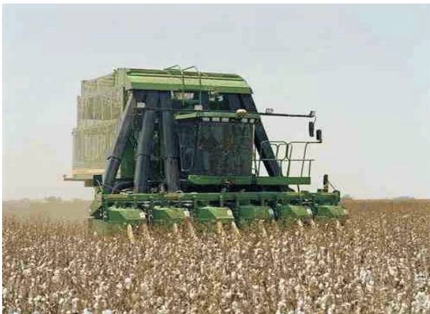
Figure 2.1: Récolteuse mécanique de type picker
