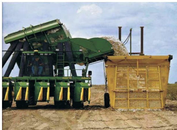
Figure 2.4: Récolteuse de type picker déversant le coton dans un compacteur de module
